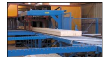
CNC-Abbund bietet hohe Präzision bei der Montage
