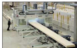
Fünfachsigte Abbundanlage für Großbauteile
